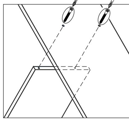
Отверстия диаметром 5 мм
